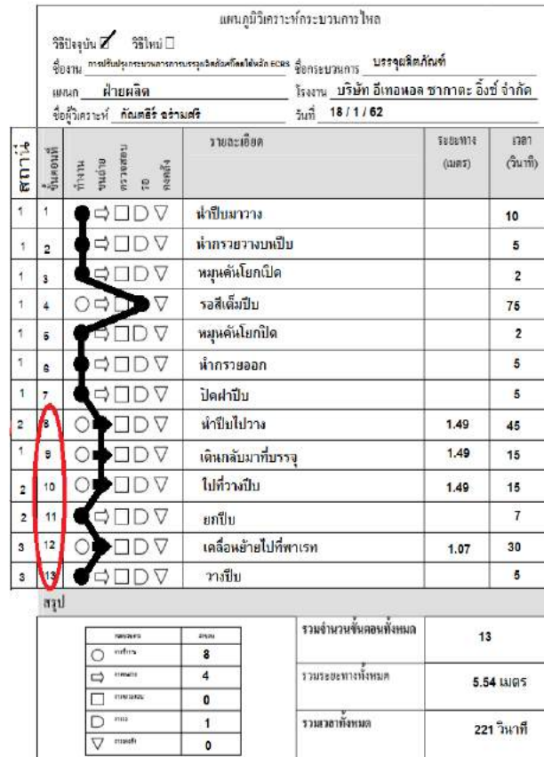
รูปที่ 4. 4 แผนภูมิกระบวนการผลิตแบบต่อเนื่อง (Flow Process Chart) ก่อนปรับปรุง
